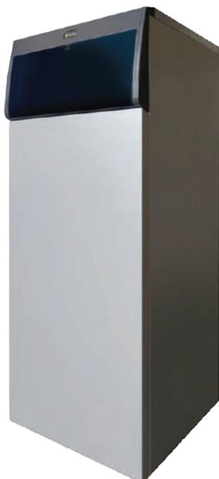
Напольный чугунный газовый двухконтурный котёл FABULA E с открытой камерой сгорания и встроенным бойлером-аккумулятором ГВС предназначен для отопления и горячего водоснабжения помещений различного назначения. Выпускается пять типоразмеров номинальной теплопроизводительностью от 27 до 43 кВт.
